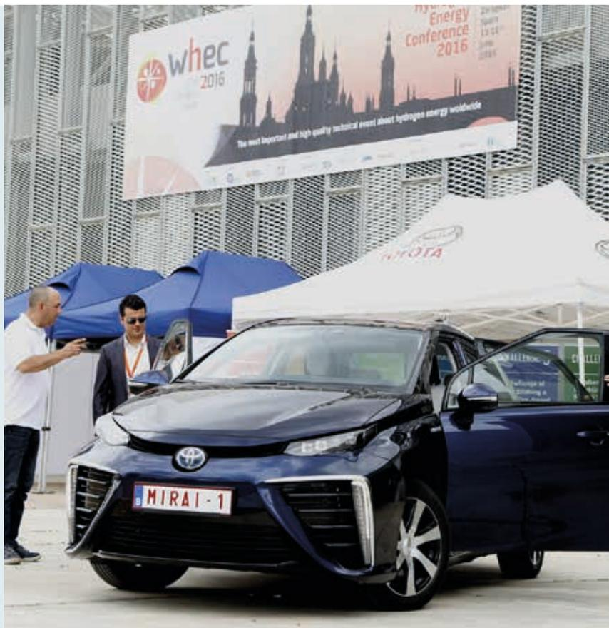
El Mirai es la primera berlina de pila de combustible producida en serie en el mundo, fruto de la labor de investigación y desarrollo de Toyota. Utiliza el hidrógeno como fuente de energía para generar la electricidad que alimenta el motor eléctrico encargado de accionar las ruedas, además de almacenarse la electricidad sobrante en una batería que se utiliza
